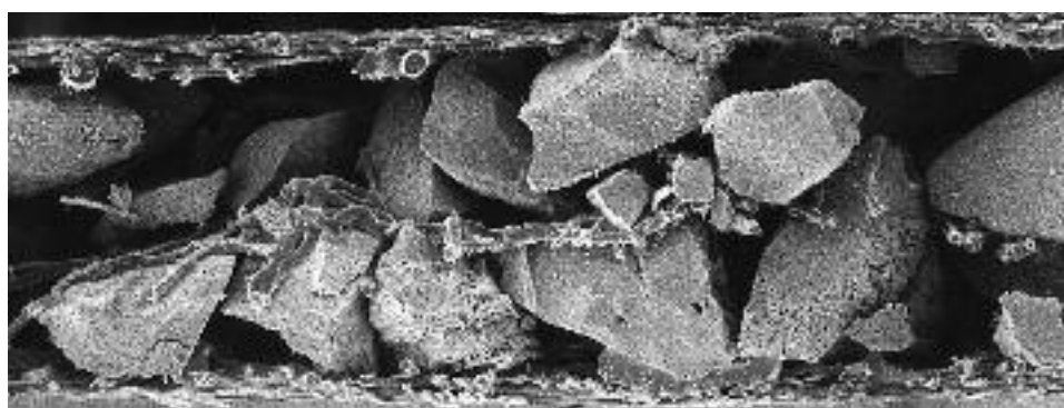
Das Bild zeigt eine Makroaufnahme von hochwertiger Kohle mit 1000-1200 m 2 /g innerer Oberfläche als Adsorptionsmittel mit einem grossen Anteil an Mikroporen.
